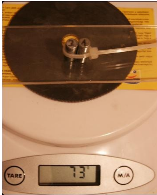
4. ábra. Az 1.-es és 2.-es mágnesek azonos polaritással összeszorítva
