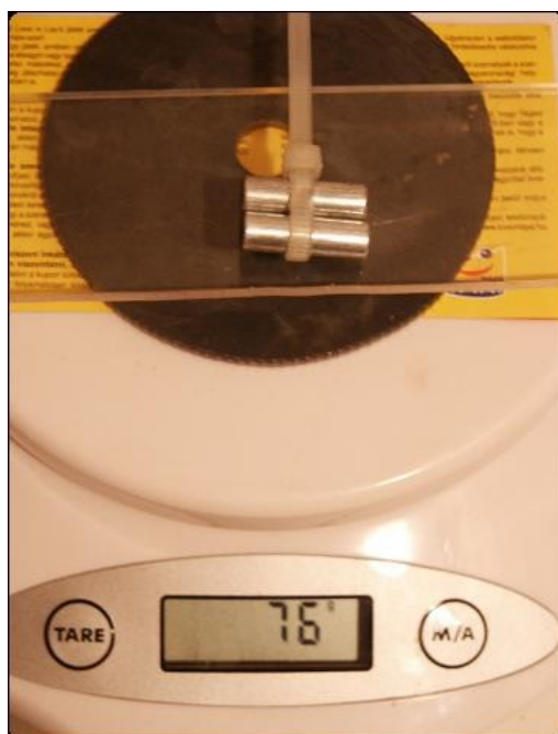
5. ábra. Az összeszorított mágnesek fekvő helyzetben
