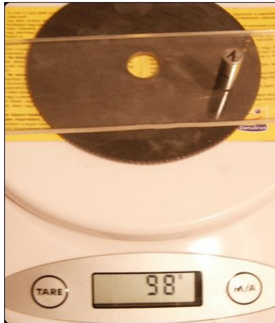
2. ábra. Az 1.-es mágnes hatására a vas alátét súlya lecsökken
